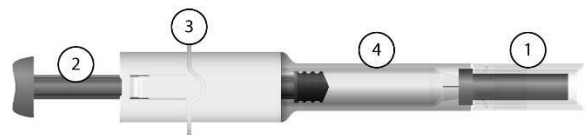
Bild 1: Spritze mit automatischem Sicherheitssystem
