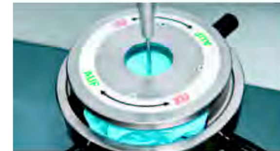
Materialprüfung auf Durchstichfestigkeit
