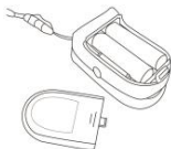
Fig. 3 Installation des piles
