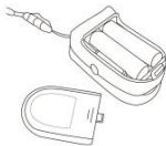
Fig. 3 Colocación de baterías
