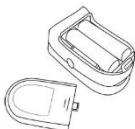
Figura 3 Colocación de baterías
