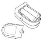
Fig. 3 Installation des piles
