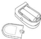
Fig. 3 Installation av batterier
